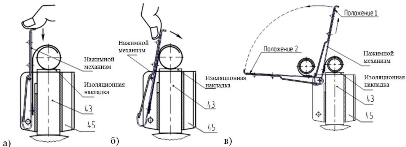
Рисунок 14 – Положение нажимного механизма при замене щеток
