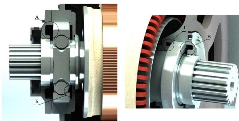
Рисунок 18 – Пополнение смазки в подшипниковых узлах
