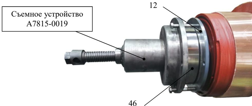
Рисунок 16 – Демонтаж подшипников
