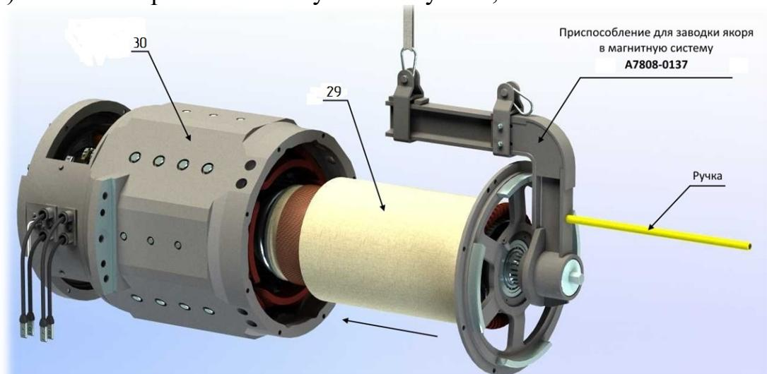
Рисунок 19 – Заводка якоря в магнитную систему
