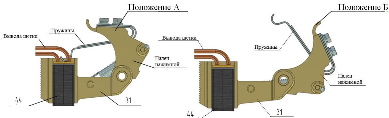
Рисунок 13 – Положение нажимного механизма при замене щеток
