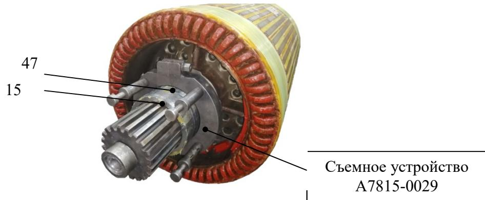
Рисунок 17 – Демонтаж подшипников
