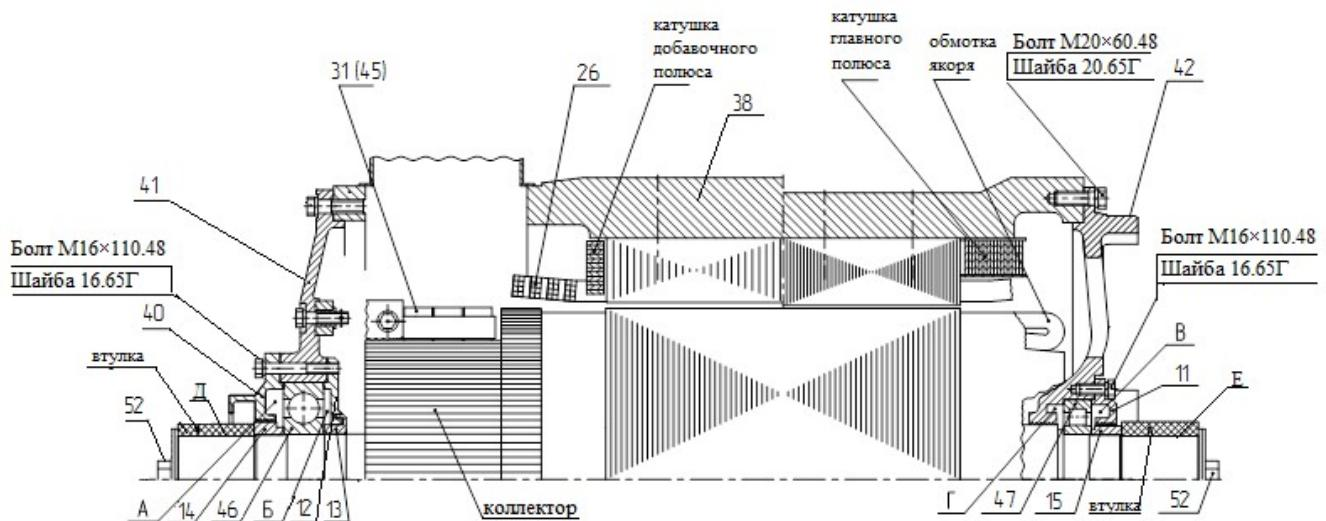
Рисунок 15 – Общий вид электродвигателя тягового ЭДП-600
