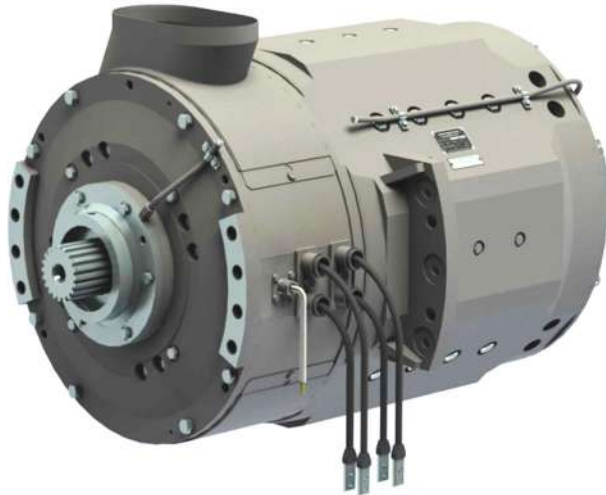
Рисунок 1 – Модель электродвигателя ЭДП-600 (вид со стороны коллектора)
