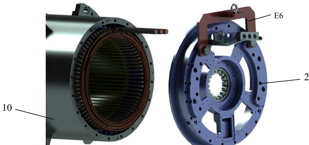
Рисунок 24б – Демонтаж подшипникового щита (сторона тормоза)
