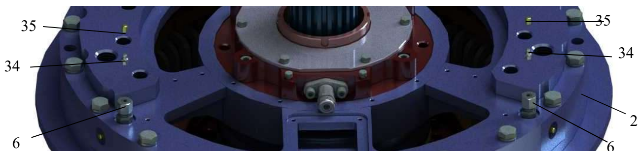
Рисунок 46 – Монтаж масленок, резьбовых соединений, трубок для пополнения смазки
