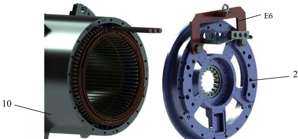
Рисунок 24б – Демонтаж подшипникового щита (сторона тормоза)
