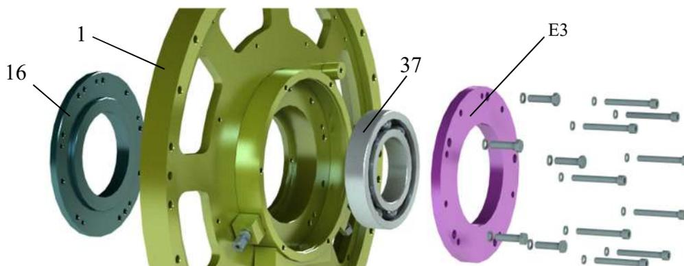
Рисунок 28 – Демонтаж деталей из подшипникового щита (сторона привода)
